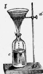
Фиг. 11. Приборъ для фильтрованія.
