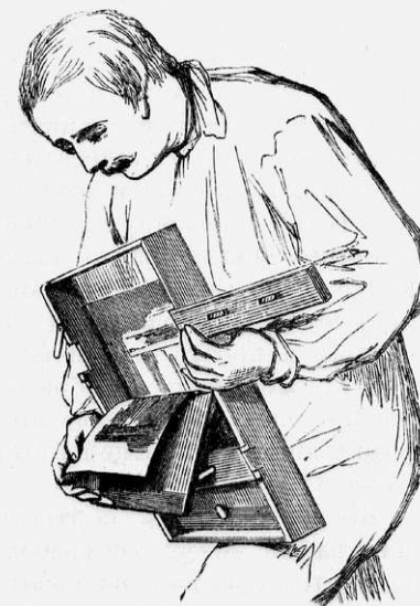
Фиг. 94. Какимъ образомъ разсматривать дѣйствіе свѣта на чувствительную бумагу.
